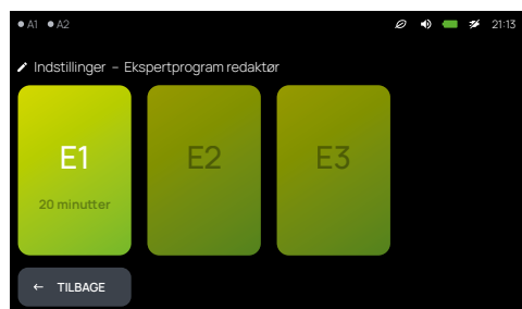
Programeditor til indstilling af brugerdefinerede programforløb og plus-signal-betjeningsselementet.
